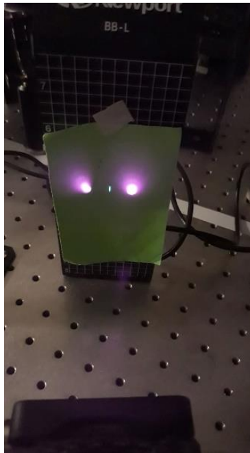
Figura 7. Semnalul armonicii a doua (400nm) se afla in mijlocul celor doua fascicule a caror lungime de unda este de 800nm
